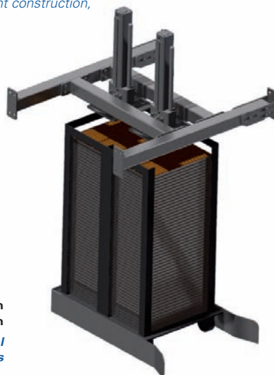
3D-Ansicht einer externen Pressvorrichtung für Hordenwagen 3D Picture of an external moulding press for rack trolleys
