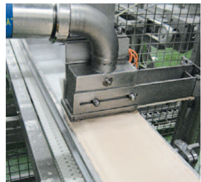
Füllvorgang mit speziell an die Form angepasstem Füllkopf. Filling process with filling head specially matched to the pan.
